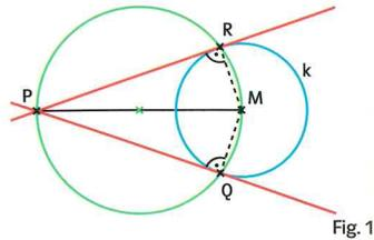
**Beispiel** Konstruktion eines rechten Winkels
