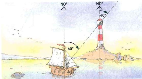
In der Schifffahrt wird die Fahrtrichtung Kurs genannt. Der Kurs wird in Grad und Minuten als Abweichung von der Nordrichtung im Uhrzeigersinn angegeben.
