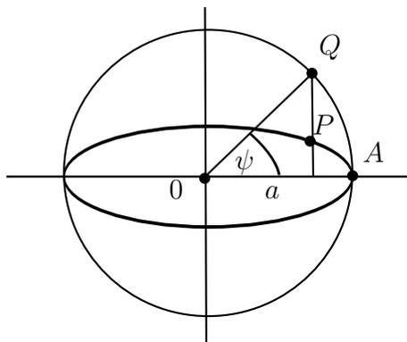
Sei dazu  $t$  die Zeit,  $t = 0$  der Zeitpunkt, an dem der Planet die große Halbachse passiert und  $\psi = \angle AOQ$  die sogenannte „Exzentrische Anomalie“ (vgl. Bild). Dann gilt folgender Zusammenhang (ohne Beweis):
