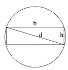
b: Breite des Balkens, h: Höhe des Balkens, d: Durchmesser des Baumstamms
