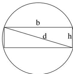
$b$ : Breite des Balkens,  $h$ : Höhe des Balkens,  $d$ : Durchmesser des Baumstamms
